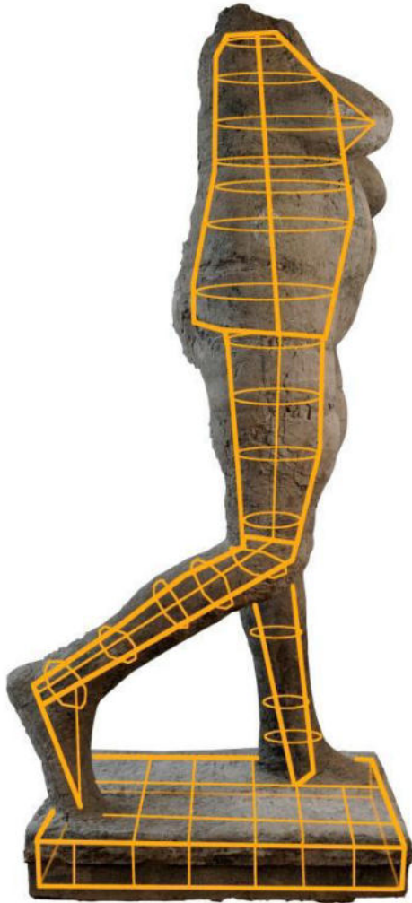
Severin Mair Rekonstruktion der Armierung mit Ferro Scan Sichtbetonkonservierung in der österreichischen Denkmalpflege
